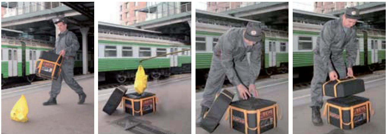
Рисунок 4. Локализаторы взрыва типа «Фонтан», порядок применения.
